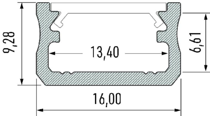
Hochwertiges Aluminiumprofil LED FORNELLS für Oberflächenmontage. Einer der einfachsten und modernsten Projekte. Profil aus der Gruppe LED FORNELLS. Vielseitig einsetzbar. Eignet sich perfekt als Dekobeleuchtung bei Möbelherstellung, wie auch Innenausbau.
